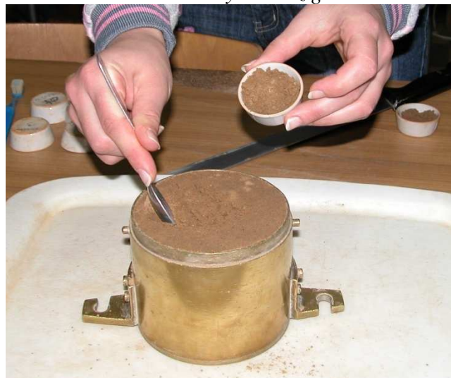
Fot. 7.4. Pobieranie próbek gruntu w celu określenia wilgotności gruntu.
